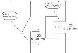
Un coupe-arc doit être fixé en place à l'aide de dispositifs mécaniques comme des attaches mécaniques.
